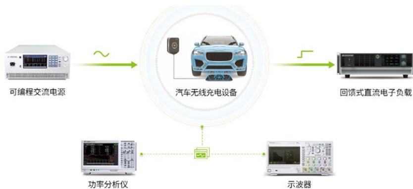
图 1 电动汽车无线充电设备的测试拓扑图
